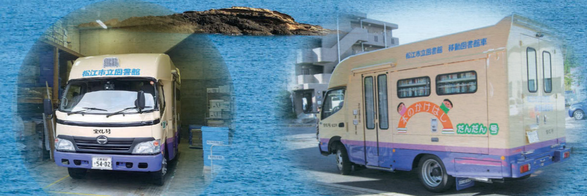
セミバス型(3トントラック改造) 排気量4,000cc
